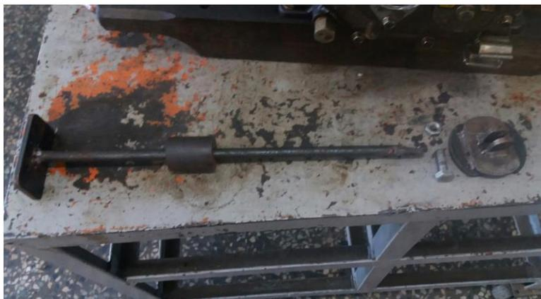
(圖二)自製的汽缸拆卸器(自攝)
