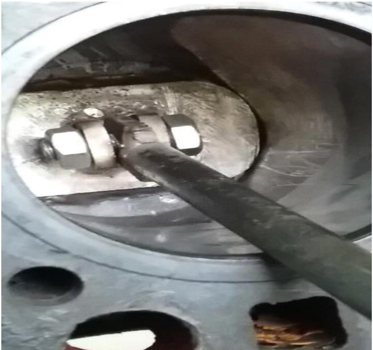
(圖八)拆卸器裝好汽缸套(自攝)
