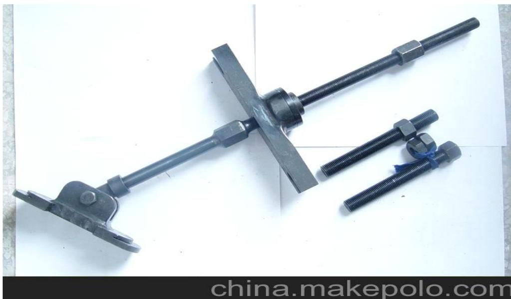
(圖一)市面上的汽缸拆卸器
