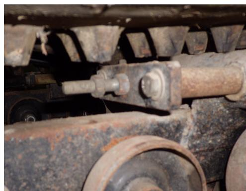
11. 履帶鬆緊度須依監評老師指定調整至 20~30mm，位置如圖示在第二滾輪與履帶之間。
