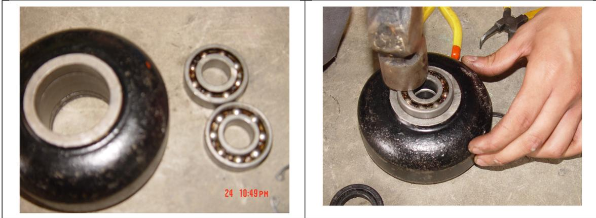
7. 選擇外徑與軸承外徑相同的套筒，以榔頭將軸承逼入。
