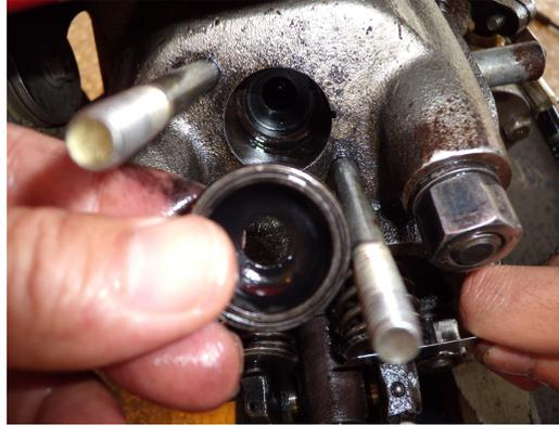
11. 裝回噴油嘴總成，裝回時二顆固定螺帽需要平均鎖緊，以免口生漏氣現象而導致無法發動。
