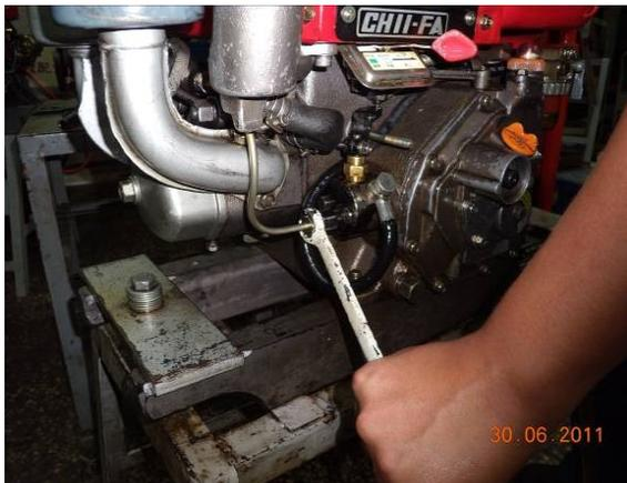
18. 請示裁判，確認可以發動引擎之後，將調速桿轉至START，扳動減壓桿發動引擎，調整調速桿以調整轉速穩定後，請裁判檢口後熄火。
