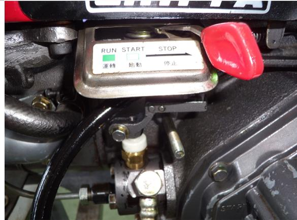
17. 準備17-19油管扳手或17梅開扳手，以準備狂車時拆下高壓油管熄火之用。
