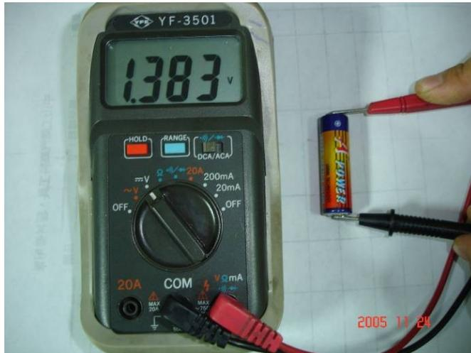
將三用電錶轉至電壓檔位，乾電池的電壓為1 . 3 8 3 V ，需注意單位為伏特 ( V ) 。
