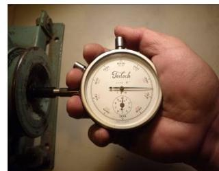
先選取適合接頭，插入測試頭。之後啟動傳動系統開關，將轉速錶插入其輸出軸，按下開關，待其指針停止轉動之後，觀察轉速錶的轉數。需注意轉速錶的總轉數需加入轉速錶小圈的轉數，一格是一千轉。
