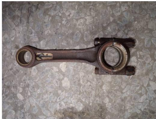
本題軸襯內徑，以游標卡尺測量連桿小端孔徑，軸襯內徑為2 5 mm。
