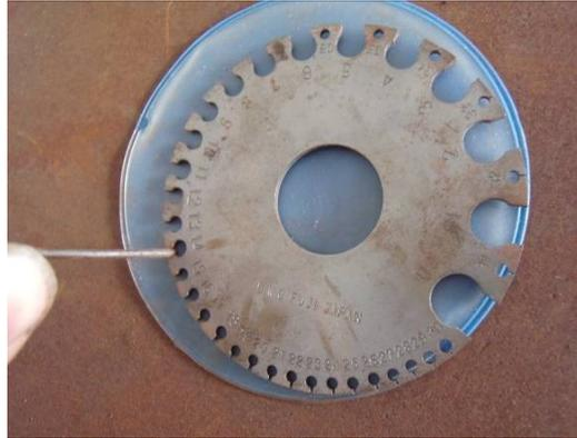
線規除了可直接測量導線直徑外，並且可以從線規刻度上看出導線的編號，號數越大線徑規格越小，使用時不可硬將待測材料塞入線規開口的地方，要以能放入的「最小缺口」為準，觀察線規缺口邊的標記，就可讀取該導線的直徑或線號。此題顯示這根鐵絲是14號線。
