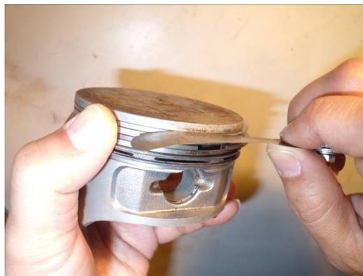
活塞環側隙測量時，需以大拇指按壓住活塞環，使用厚薄規依次從最薄的開始測量。
