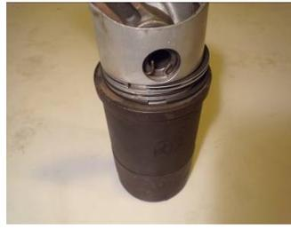
活塞環端隙量測時，須先將活塞環斜放進入汽缸內，再以活塞壓至第一道活塞環案切齊，務必使活塞環在汽缸內為水平狀態之後，以厚薄規依次從最薄的開始測量。
