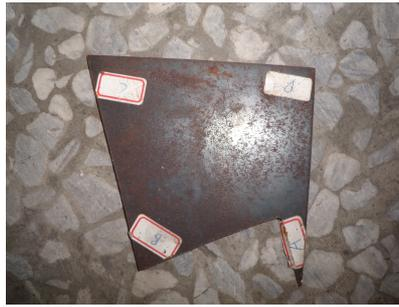
鐵板的角需使用角度規測量，測量時需將鐵塊每一個角度測量一遍，找出最小角度值。本題中上側左圖最小的角度是66度。
