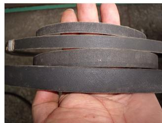
三角皮帶的型式，有M A B C D E 六種，以M 最小，因此斷面積以小至大依序排列 B 型皮帶寬度為16.5 mm，可用游標卡尺測量，所以左圖需選擇左至右的第三條皮帶(C)，才是B 型皮帶。
