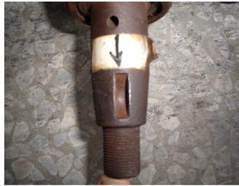
本題這個鍵的軸，鍵座深度須以游標卡尺深度規，測量指定位置之鍵座深度。
