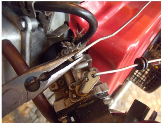
5. 拆下油管，注意取下時，勿使汽油濺出，油管底下要墊破布。
