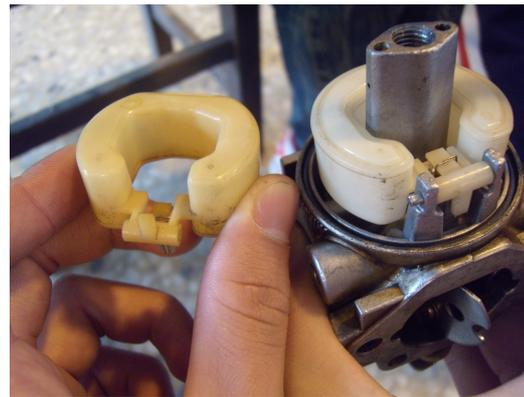
1 1 . 將化油器各油路調節螺絲旋入輕緊，記住旋轉圈數再行鬆退取下。
