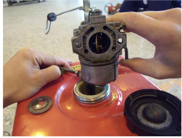
7. 拆下化油器，注意取下時，墊片勿破損。
