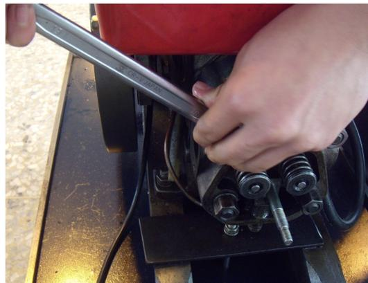
11. 取下汽缸床墊，拆下汽缸蓋放置在擦拭紙上，以免損傷汽缸蓋平面。
