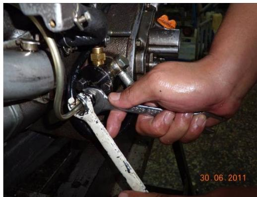
5. 使用油管扳手拆下高壓油管。
