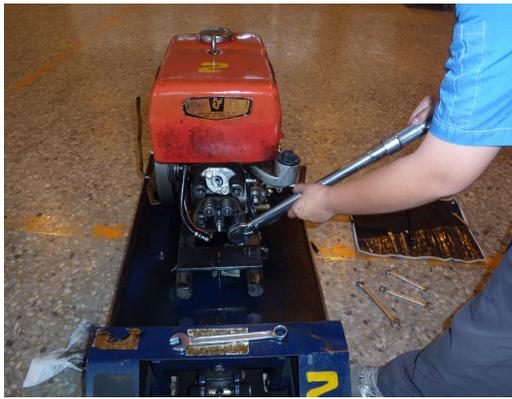
17. 裝回氣門及固定螺絲，使用扭力扳手依規定扭力鎖緊至3.5 kg-m。注意排氣門搖臂上方為方形。
