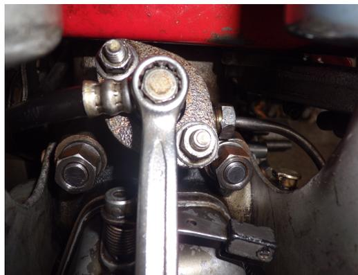
7. 使用梅花扳手拆下搖臂室蓋，拆下排水螺栓（排水），拆下機油螺栓，拔下冷卻水橡皮管。
