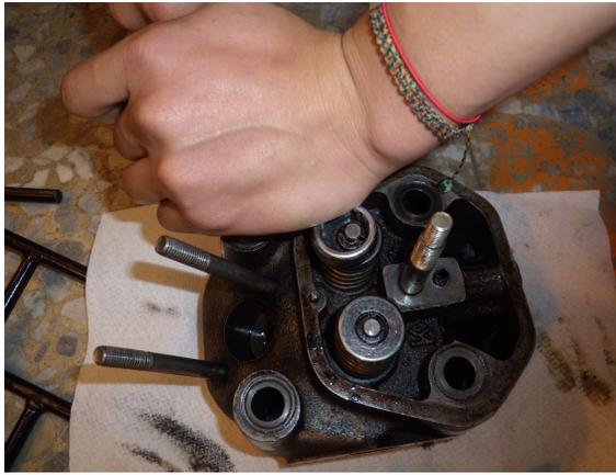
15. 裝回汽缸，鎖回汽缸螺絲，使用扭力扳手依規定扭力分三次鎖緊至7.5 kg-m。
