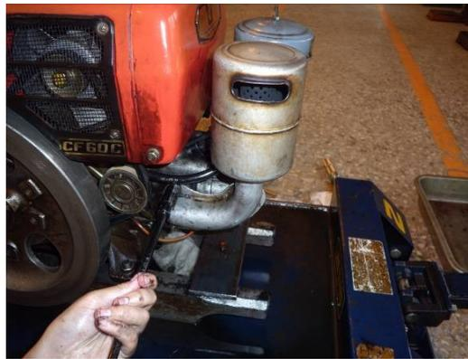
3. 將飛輪逆時針搖轉至T D 上死點，確認為壓縮上死點。
