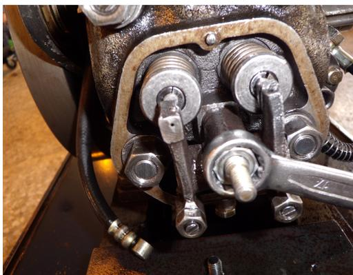
19. 調整氣門間隙，進氣門為0.25 mm，排氣門為0.3 mm（調氣門間隙時應在壓縮上死點）
