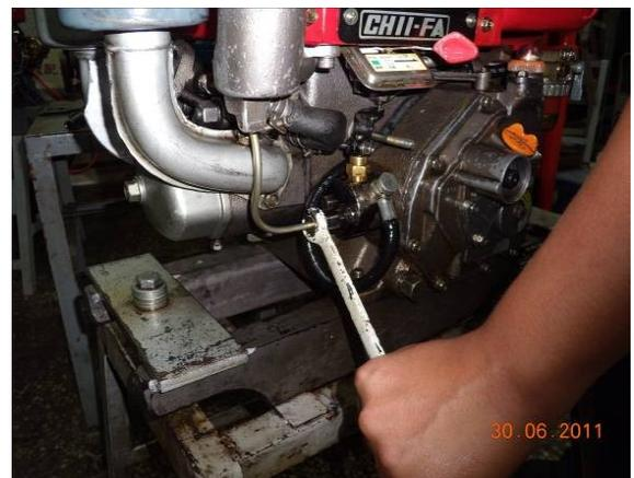
29. 請示裁判，確認可以發動引擎之後，將調速桿調整至運轉（S T A R T），發動引擎，調整調速桿以調整轉速穩定後，請裁判檢查後熄火。
