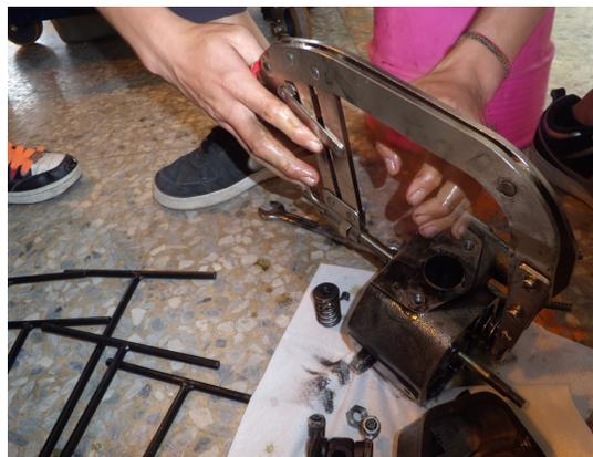
13. 裝回氣門時彈簧需注意方向，間隔大朝上方。裝回氣門彈簧鎖扣使用橡膠榔頭輕敲氣門，測試有無裝好。
